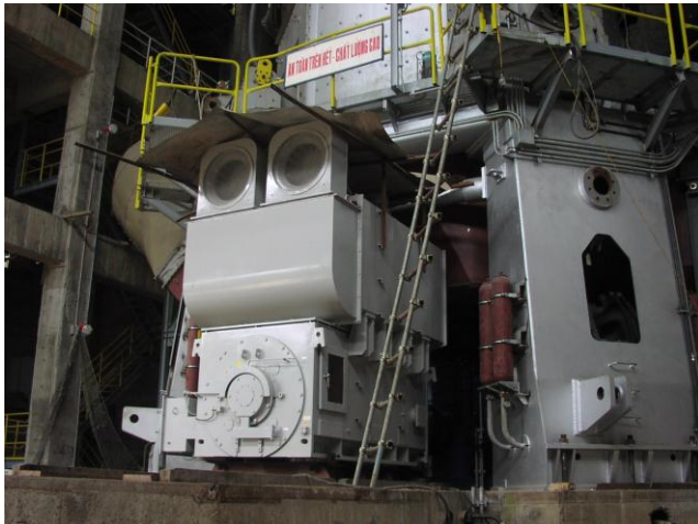
Chế tạo máy nghiền thô nghiền liệu cho nhà máy Xi măng Bim Sơn 3
